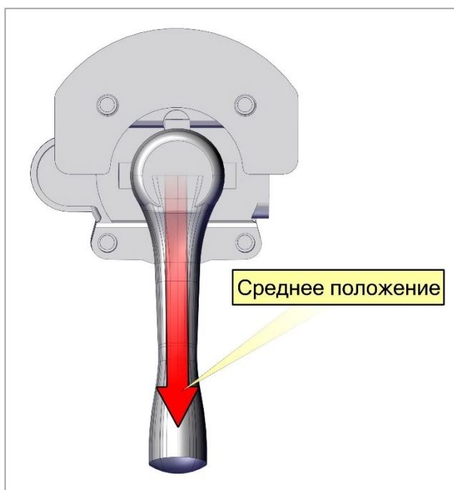
Рис. 29.6. Кран управления пневмоподвеской транспортное (среднее) положение
