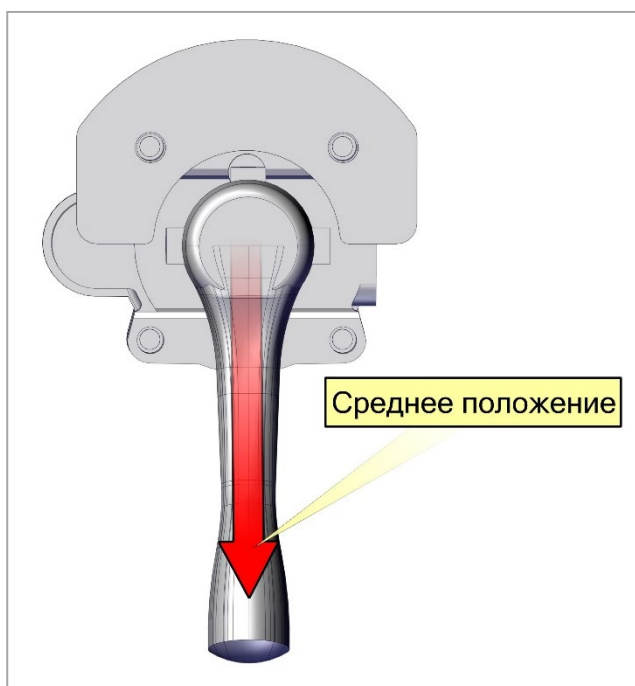
Рис. 28.6. Кран управления пневмоподвеской транспортное (среднее) положение
