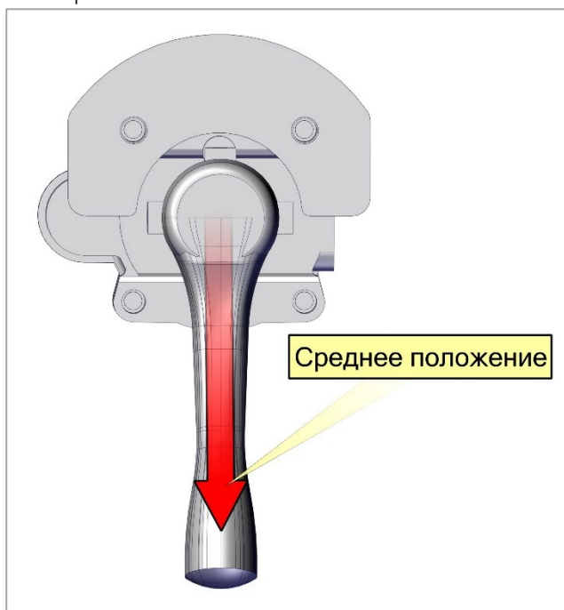
Рис. 29.6. Кран управления пневмоподвеской транспортное (среднее) положение
