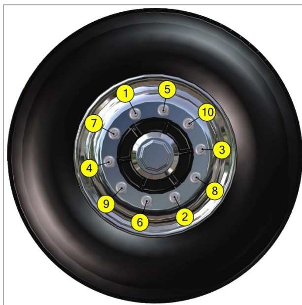
Рис. 27. Затяжка гаек.
