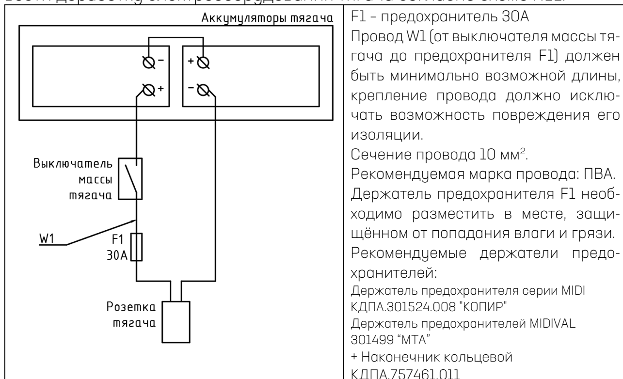
Схема №1. Доработка электрооборудования тягача
