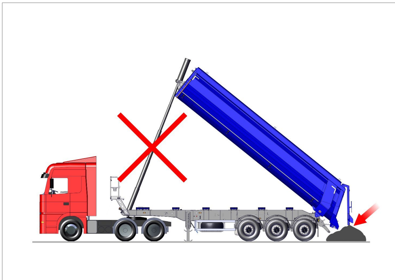
Рис. 78. Задний борт не должен упираться в препятствие
