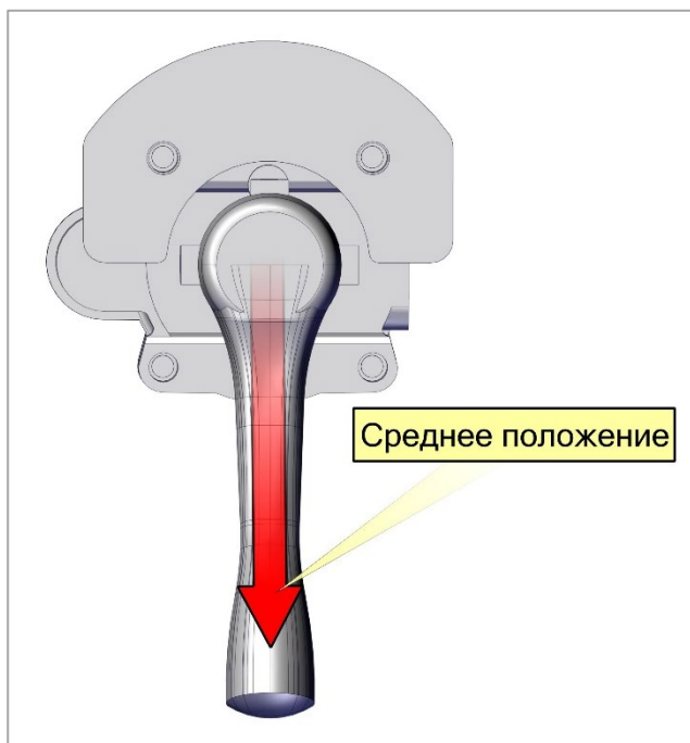
Рис. 55. Кран управления пневмоподвеской транспортное (среднее) положение
