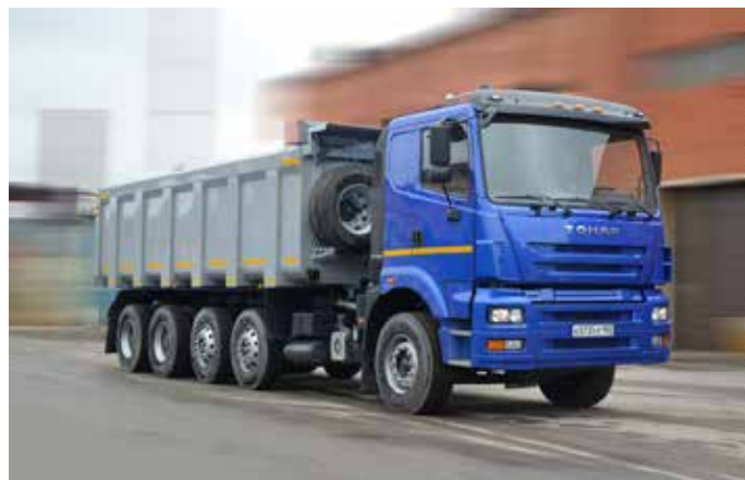
Автомобиль-самосвал с колесной формулой 10x4
