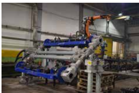
Роботизированный комплекс по сварке балки оси
