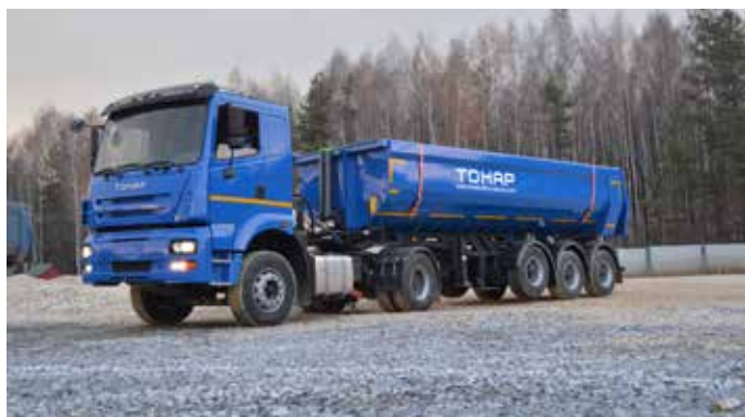
Тягач Тонар-5422 с колёсной формулой 4x2 и самосвальный полуприцеп Тонар-952302. Собственный вес всего 13,5 тонн!
