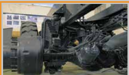
Средний мост 25 т Передаточное отношение главной передачи - 14,298
