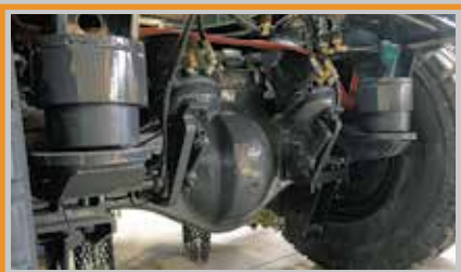
Задний мост Блокировки межколёсные и межосевые
