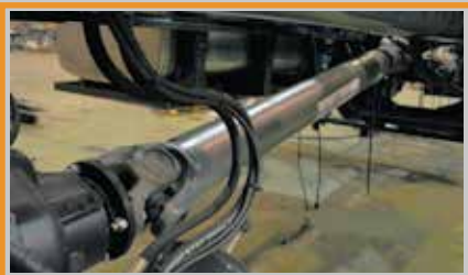
Карданный вал - открытый типа с игольчатыми подшипниками
