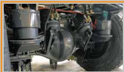
Задний мост Блокировки межколёсные и межосевые
