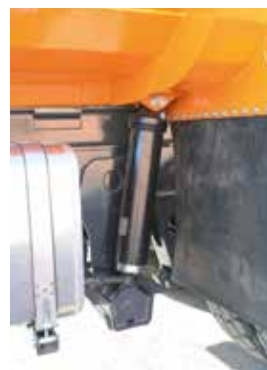
Гидроцилиндры расположены под кузовом
