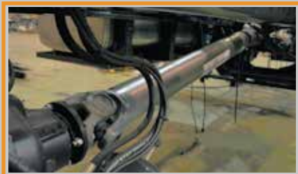
Карданный вал - открытый типа с игольчатыми подшипниками
