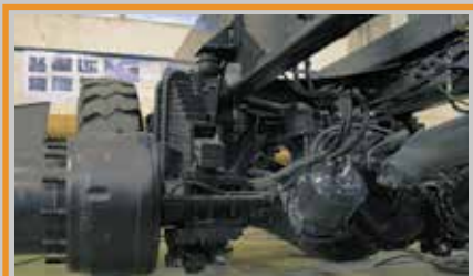
Средний мост 25 т Передаточное отношение главной передачи - 14,298
