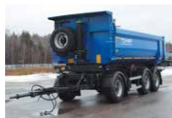
Модель 85792: Удлиненное дышло для разгрузки без расщепления; Тент, сворачивающийся вперёд на инерционный барабан.
