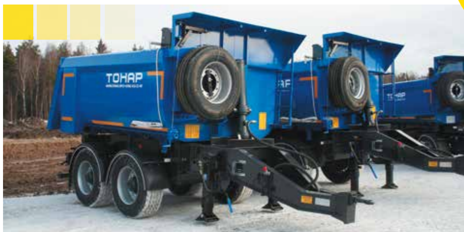
Модель 85792: Удлиненное дышло для разгрузки без расщепления; Тент, сворачивающийся вперёд на инерционный барабан.
