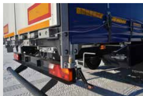
Механизм натяжки тента
