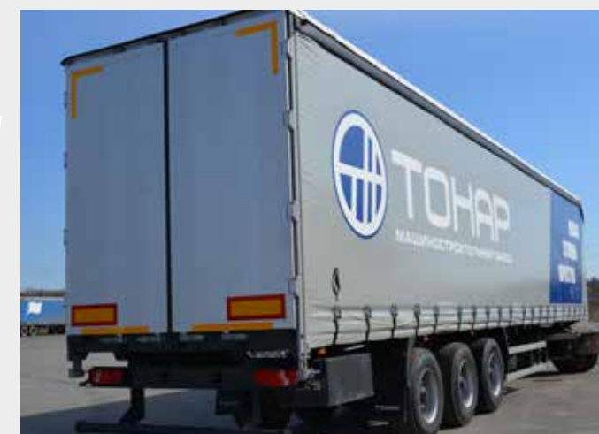
Тонар-97461-0000082 Полуприцеп тентовый со сдвижной крышей и сдвижными боковинами
