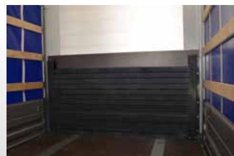
Крепление неиспользуемых коников с внутренней стороны переднего щита.
