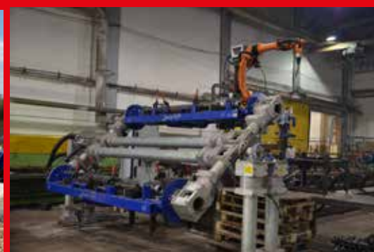
Роботизированный комплекс по сварке балки оси
