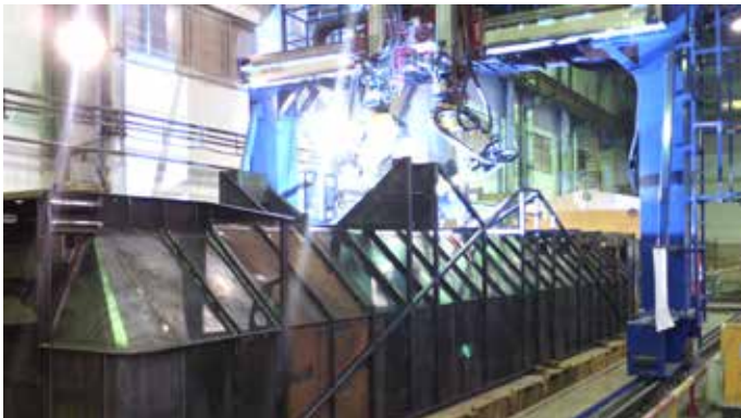
Робототехнический комплекс сварки кузовов
