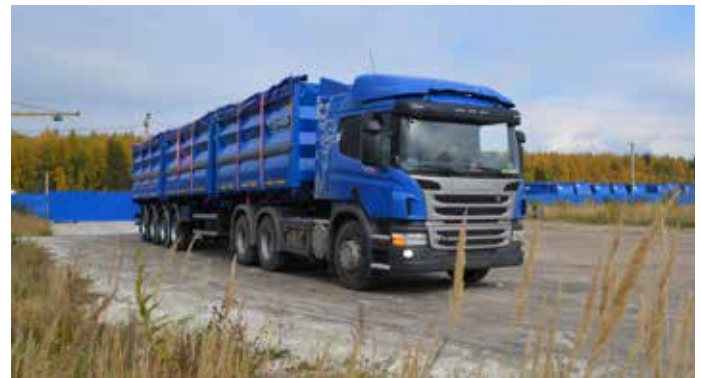
Тонар-9585-000020 Трёхсекционный самосвальный полуприцеп 4-х осный
