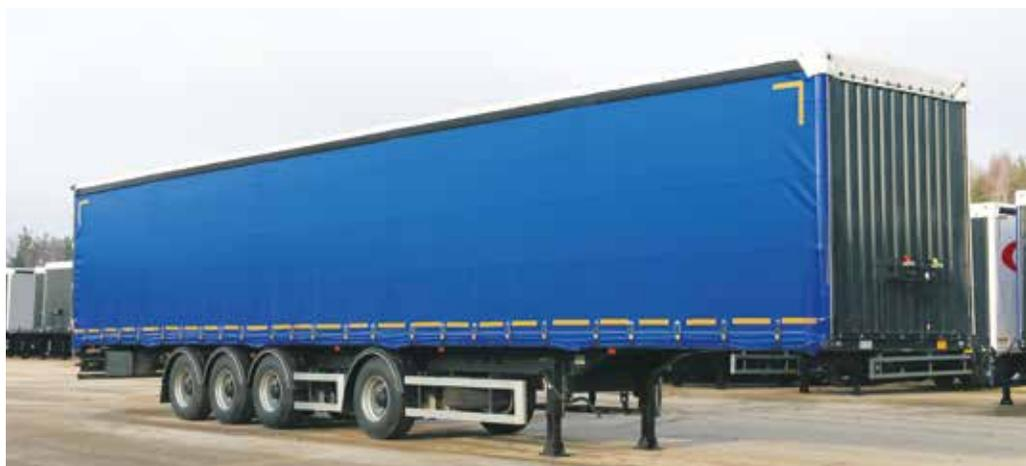
Первая ось - подъёмная, с возможностью управления из кабины тягача (возможность подъёма в гружёном состоянии на длительный период времени), вторая или четвёртая ось - подъёмная.
