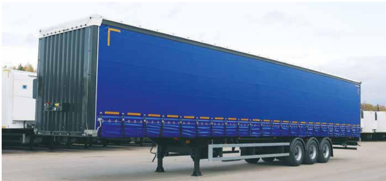
Шторный полуприцеп со сдвижной крышей и сдвижными боковинами
