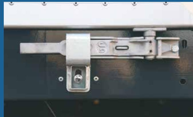
Пластина кожуха на запор алюминиевых дверей шторных полуприцепов, фиксация осуществляется посредством болтов секретного типа.
