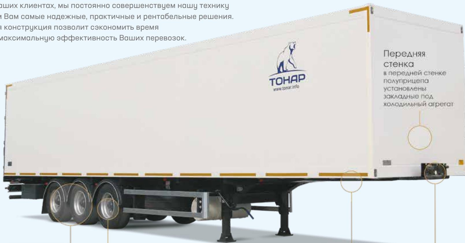
Передняя стенка в передней стенке полуприцепа установлены закладные под холодильный агрегат
