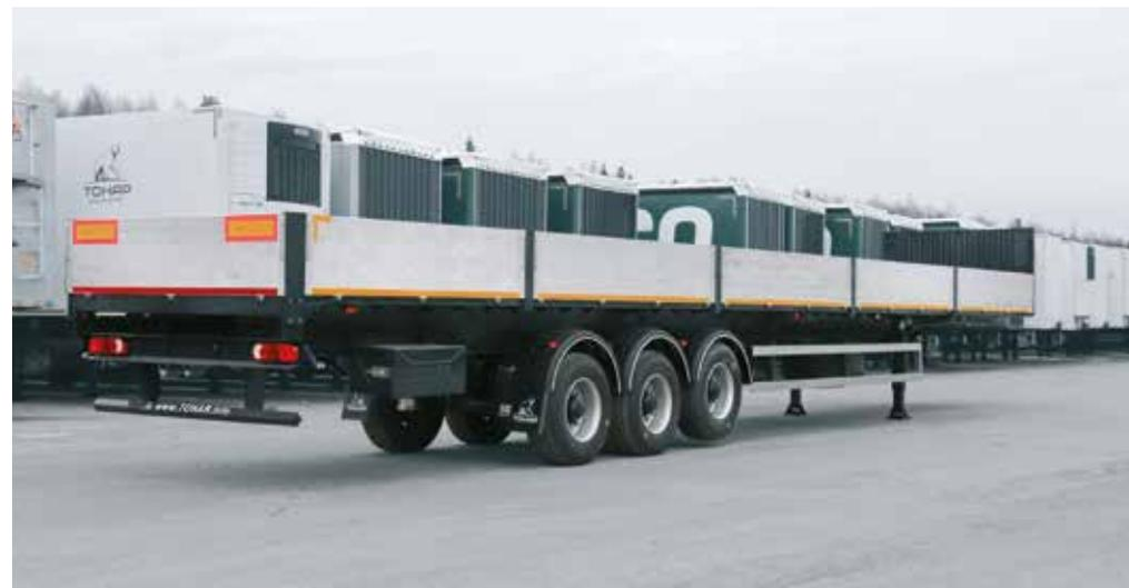
Первая ось - подъёмная, с возможностью управления из кабины тягача (возможность подъёма в гружёном состоянии на длительный период времени).
