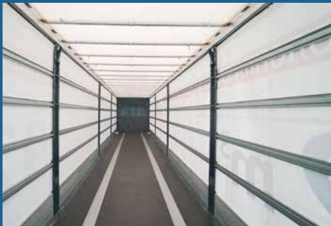
Стальные доски делают конструкцию кузова более прочной, эстетичней и долговечней, чем при использовании деревянных или фанерных досок, при этом не увеличивая вес полуприцепа
