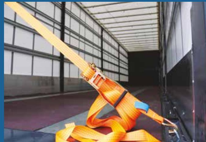
Для усиления каркаса тента при движении незагруженного или частично загруженного полуприцепа необходимо установить ремни крепления
